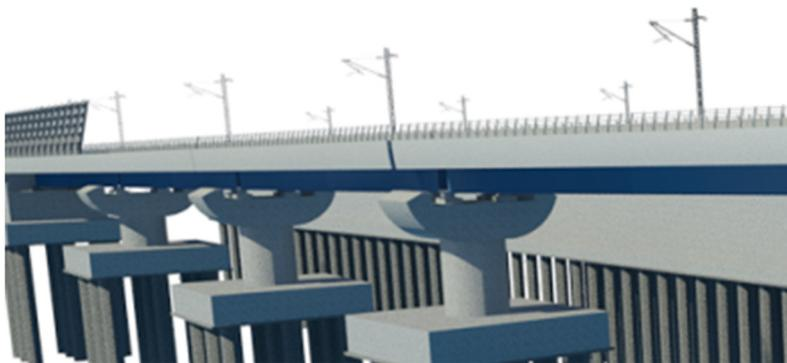
Figura 12. Vista prospettica - Ponte a struttura mista acciaio calcestruzzo a singolo binario
