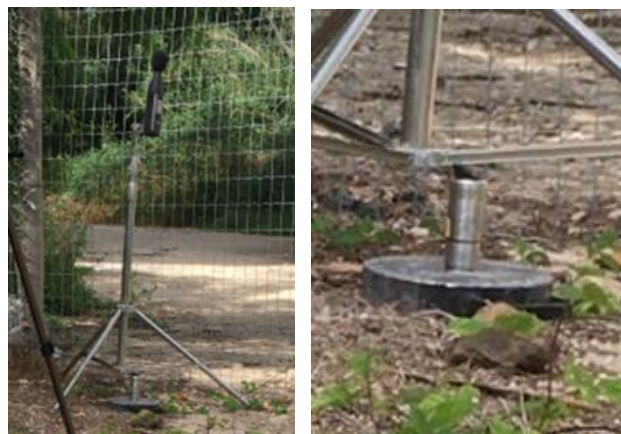
Figura 3-2 Esempio di installazione dell'accelerometro
