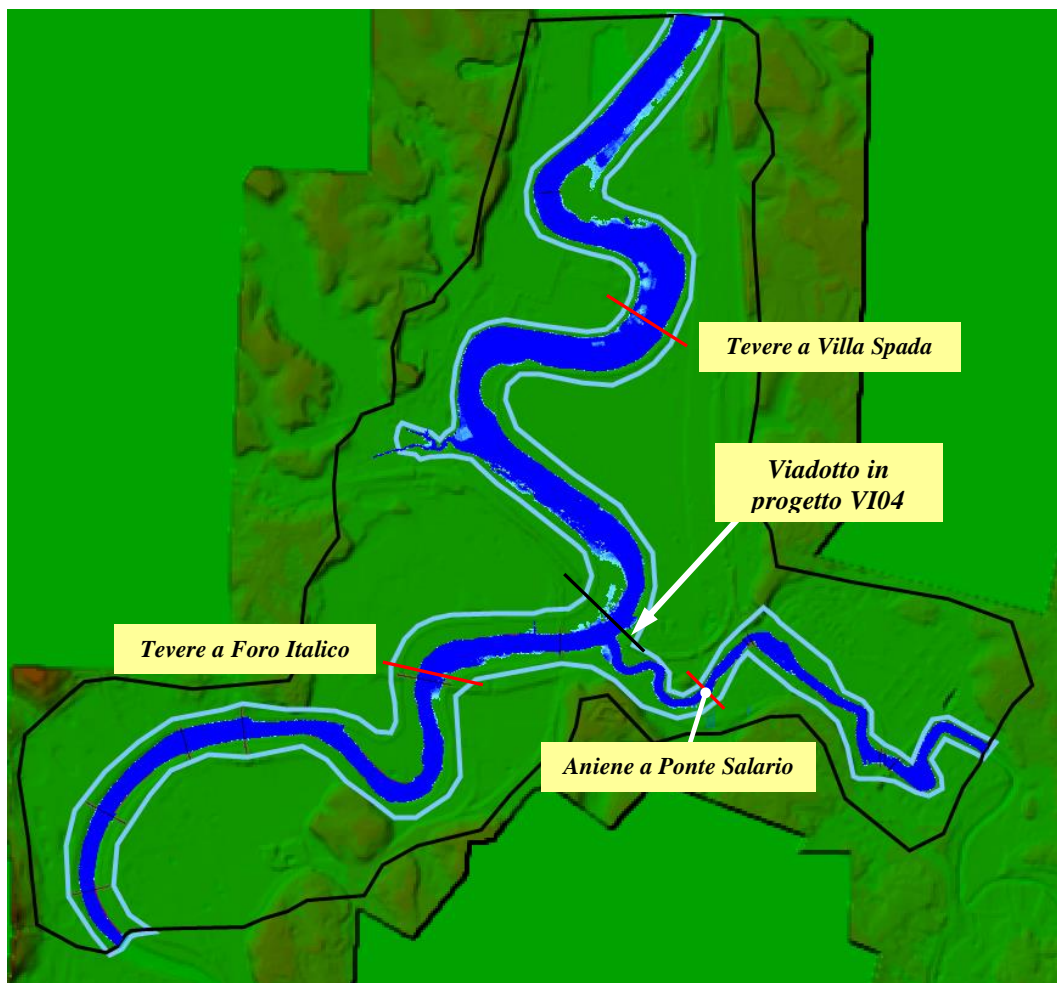
Figura 22 – Calibrazione del modello 2D del Fiume Tevere e Fiume Aniene: aree potenzialmente inondabili (evento del 2014).
