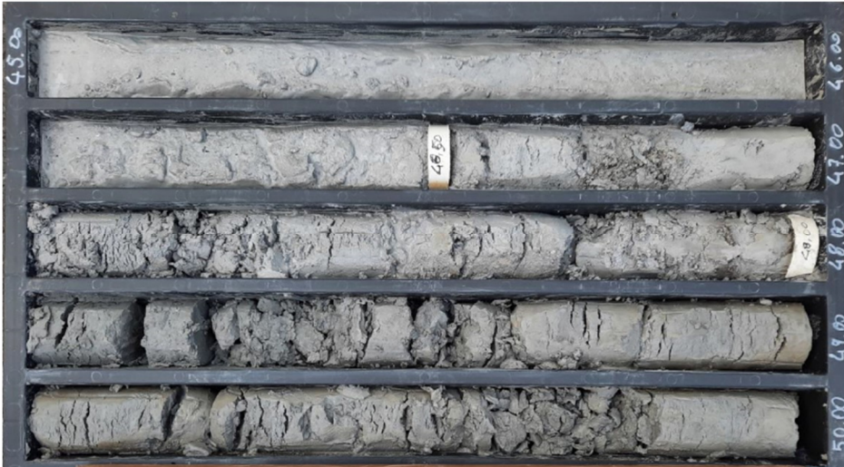
Litofacies sabbioso-limosa della Formazione di Monte Mario (MTM) in corrispondenza del foro di sondaggio SG5.
