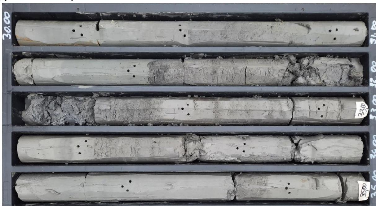
Figura 13 – Litofacies argilloso-sabbiosa della Formazione di Ponte Galeria (**PGL3b**) in corrispondenza del foro di sondaggio SG5.
