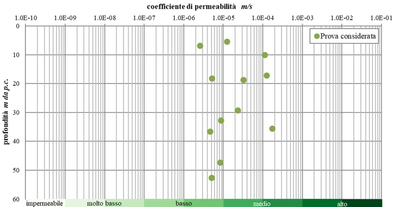
Figura 29 - Grafico di distribuzione del coefficiente di permeabilità in funzione della profondità per i Depositi sabbioso-limosi (DSL).
