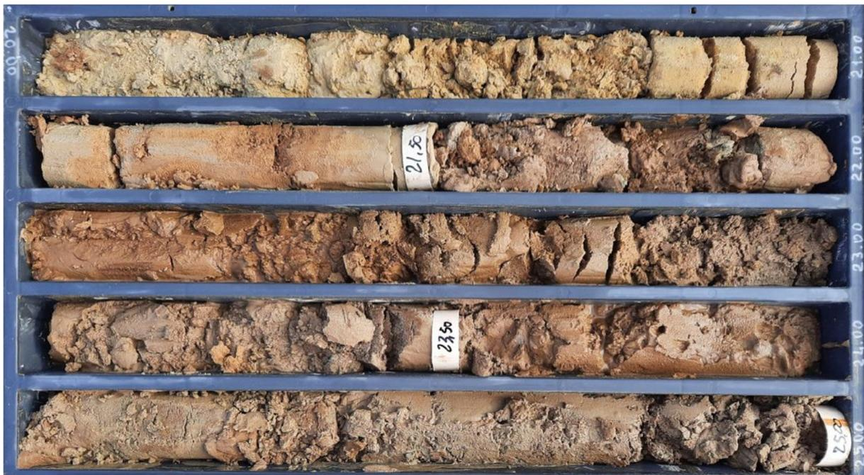
Figura 12 – Litofacies sabbioso-limosa della Formazione di Ponte Galeria (PGL3c) in corrispondenza del foro di sondaggio SG3.
