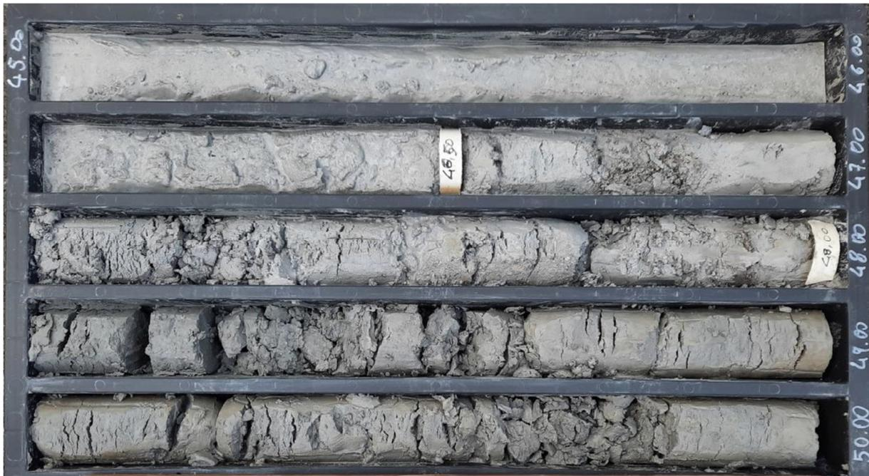
**Figura 11 – Litofacies sabbioso-limosa della Formazione di Monte Mario (MTM) in corrispondenza del foro di sondaggio SG5.**
