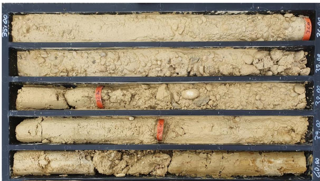
**Figura 14 – Litofacies ghiaioso-sabbiosa della Formazione del Fosso della Crescenza (FCZ) in corrispondenza del foro di sondaggio S7.**
