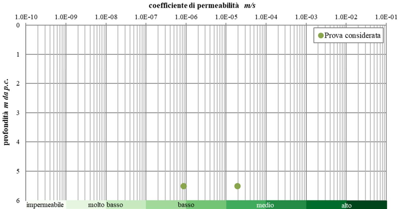
Figura 31 - Grafico di distribuzione del coefficiente di permeabilità in funzione della profondità per i Terreni di copertura (TRC).
