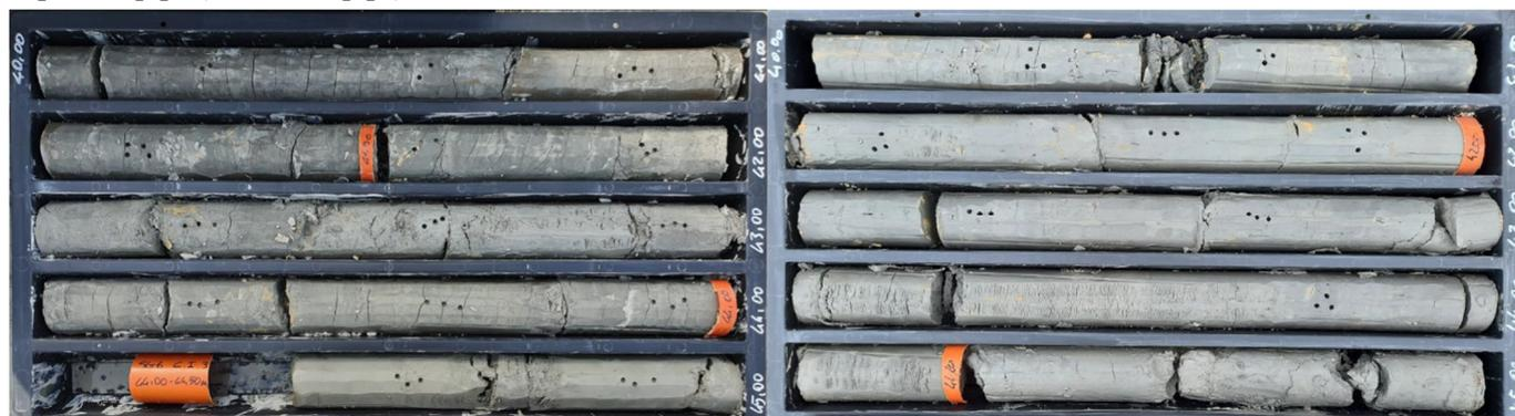
**Figura 10 – Litofacies argilloso-sabbiosa della Formazione di Monte Vaticano (MVA) nei fori di sondaggio SG6 (a sinistra) e S11 (a destra).**
