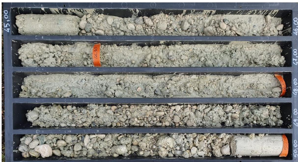
**Figura 16 – Litofacies ghiaioso-sabbiosa dei Depositi alluvionali recenti (bb1) nella parte bassa del foro di sondaggio S1.**
