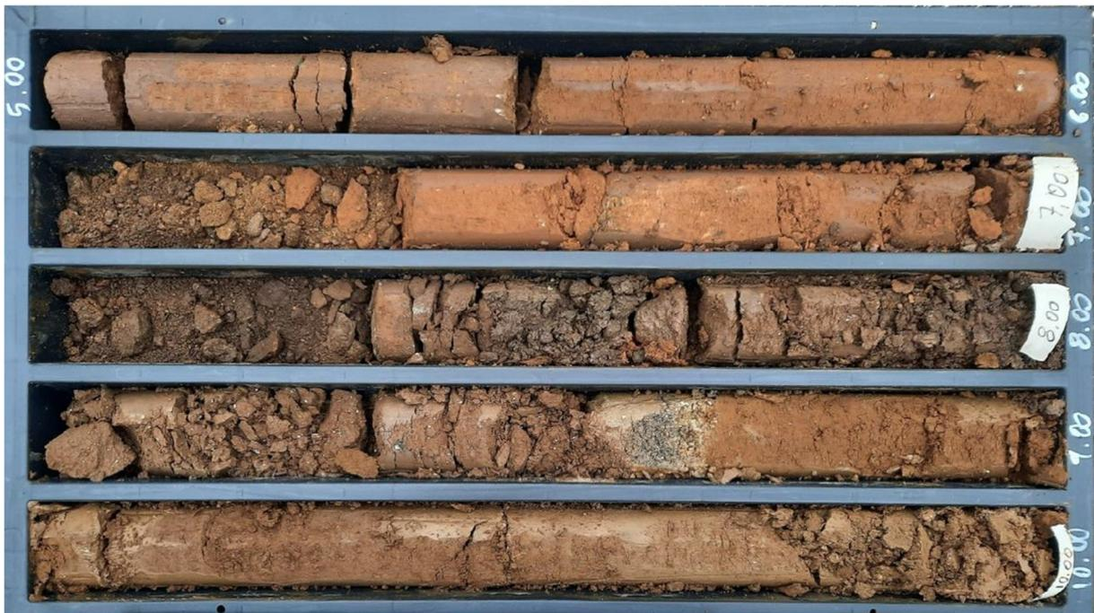
Figura 15 – Litofacies cineritico-lapillosa dei Tufi stratificati varicolori di Sacrofano (SKF) in corrispondenza del foro di sondaggio SG5.
