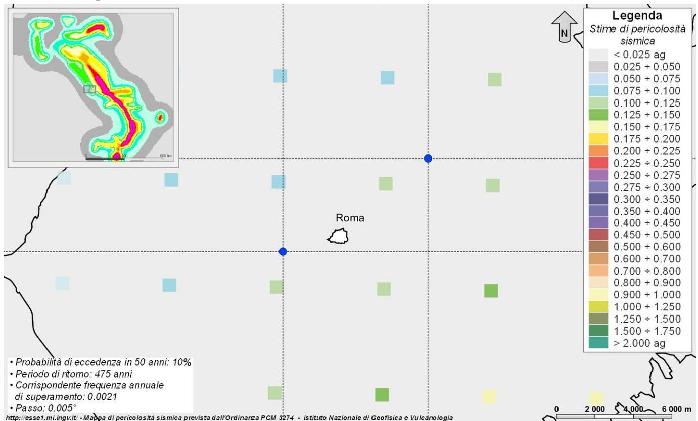
**Figura 39 – Mappa di pericolosità sismica per l'area di interesse; i colori della legenda indicano le diverse accelerazioni del suolo (<http://esse1-gis.mi.ingv.it>).**
