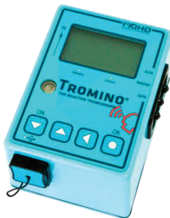
Figura 3. Tromino utilizzato per effettuare le indagini di sismica passiva di tipo HVSR.
