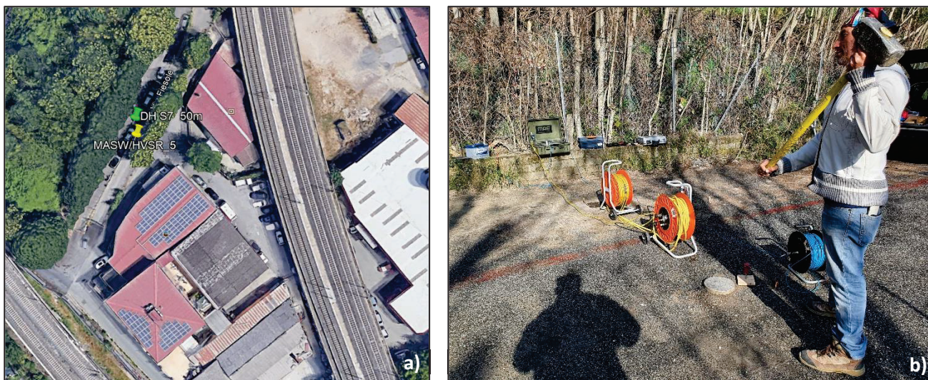
Figura 35 - Ubicazione del foro di sondaggio (a) ed esecuzione della prova Down-hole in sito (b)
