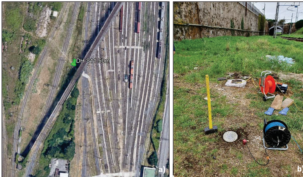
Figura 37. Ubicazione del foro di sondaggio (a) ed esecuzione della prova Down-hole in sito (b)
