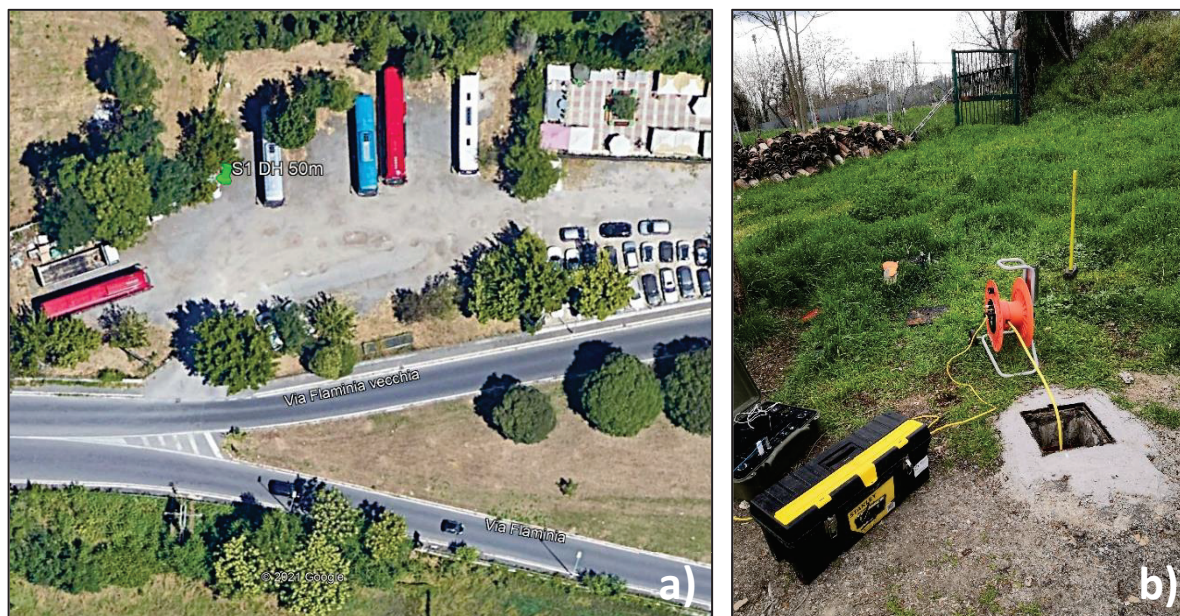
Figura 11 - Ubicazione del foro di sondaggio (a) ed esecuzione della prova Down-hole in sito (b)
