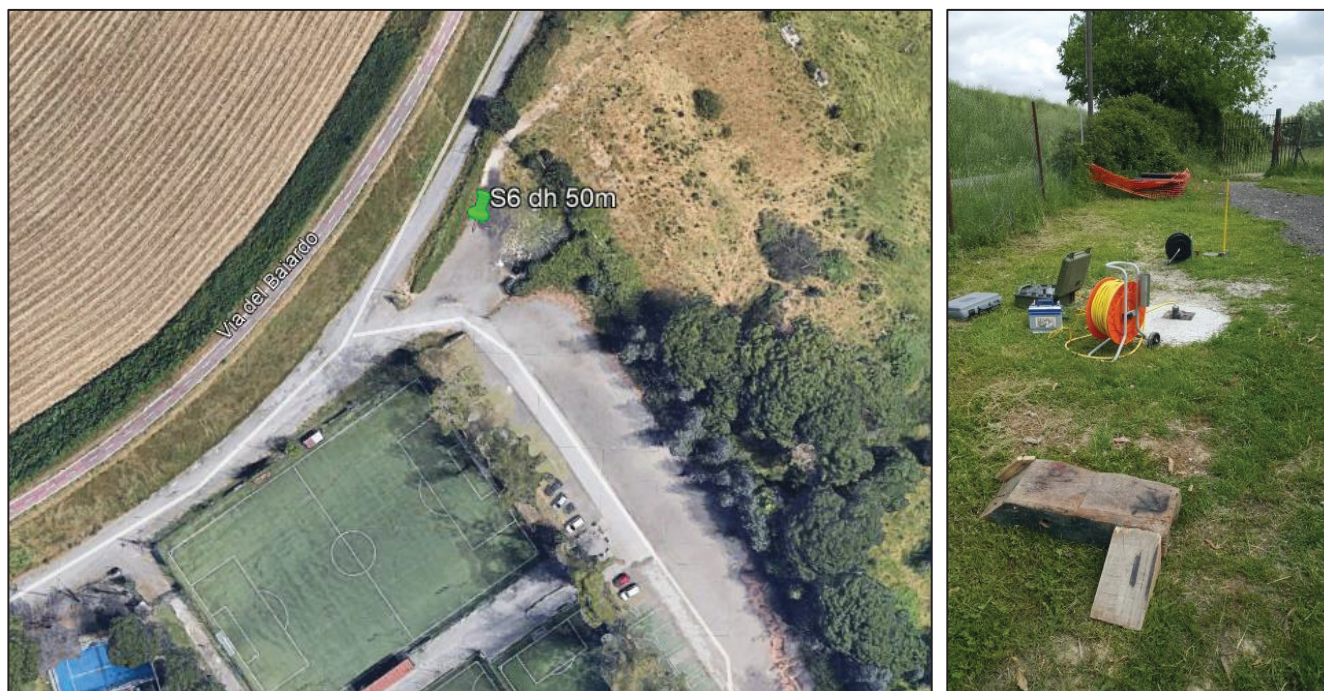
Figura 18. Ubicazione del foro di sondaggio (a) ed esecuzione della prova Down-hole in sito (b)
