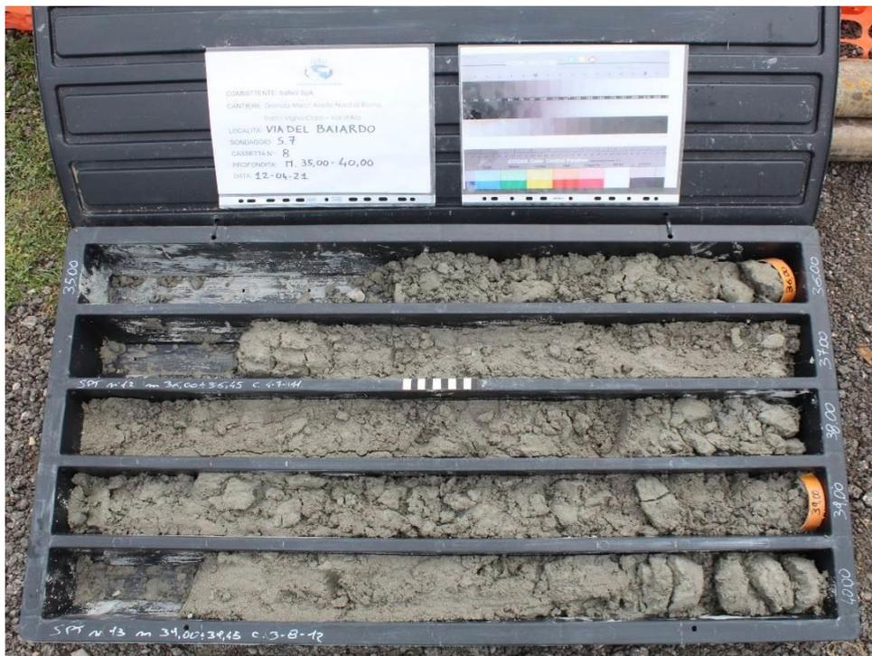
*Sondaggio S6, carote da -35,00 a -40,00 metri*
