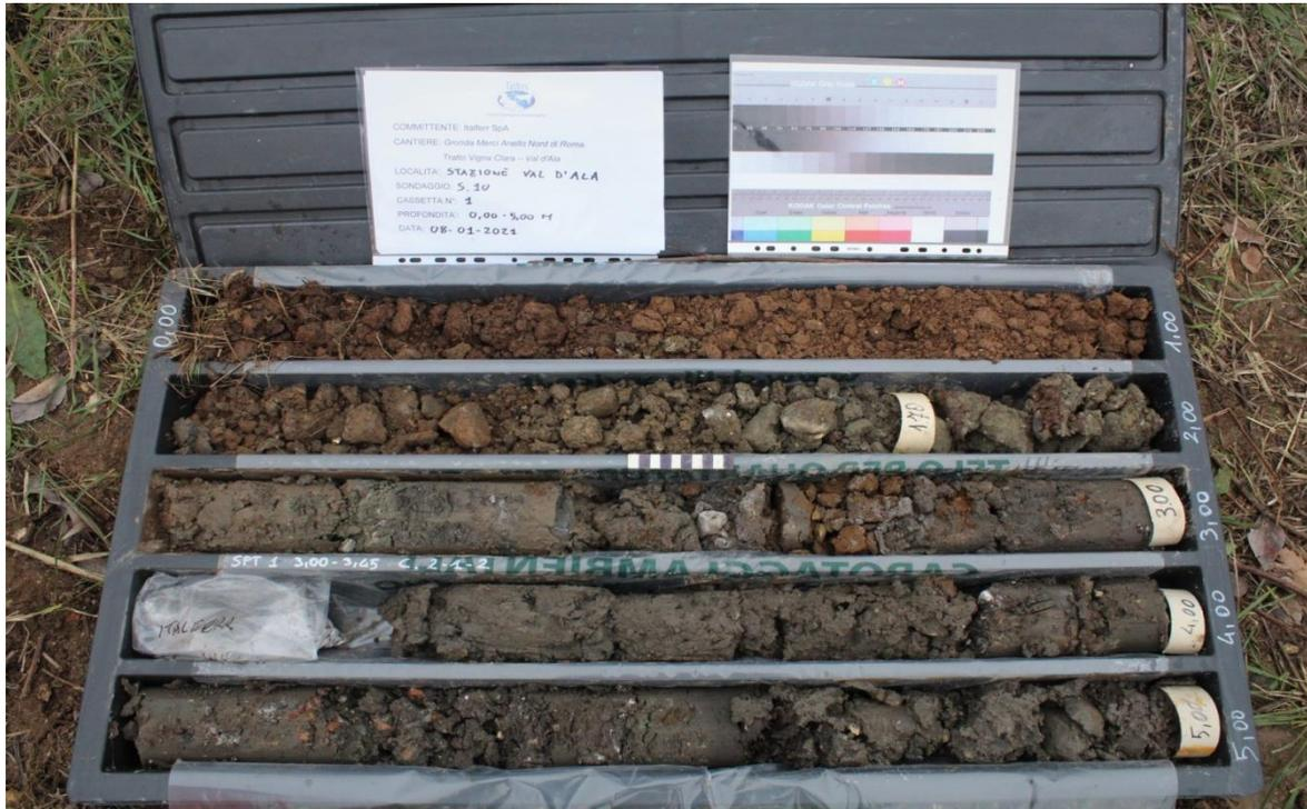
Sondaggio S10, carote da 0,00 a -5,00 metri
