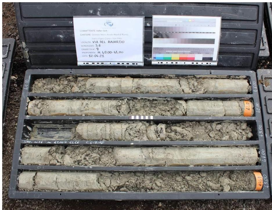
Sondaggio S6, carote da -40,00 a -45,00 metri
