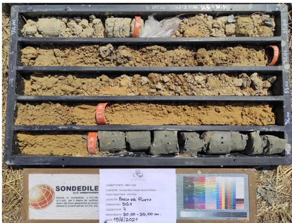
*Sondaggio SG1, cassetta 7, da -30,00 a -35,00 metri*
