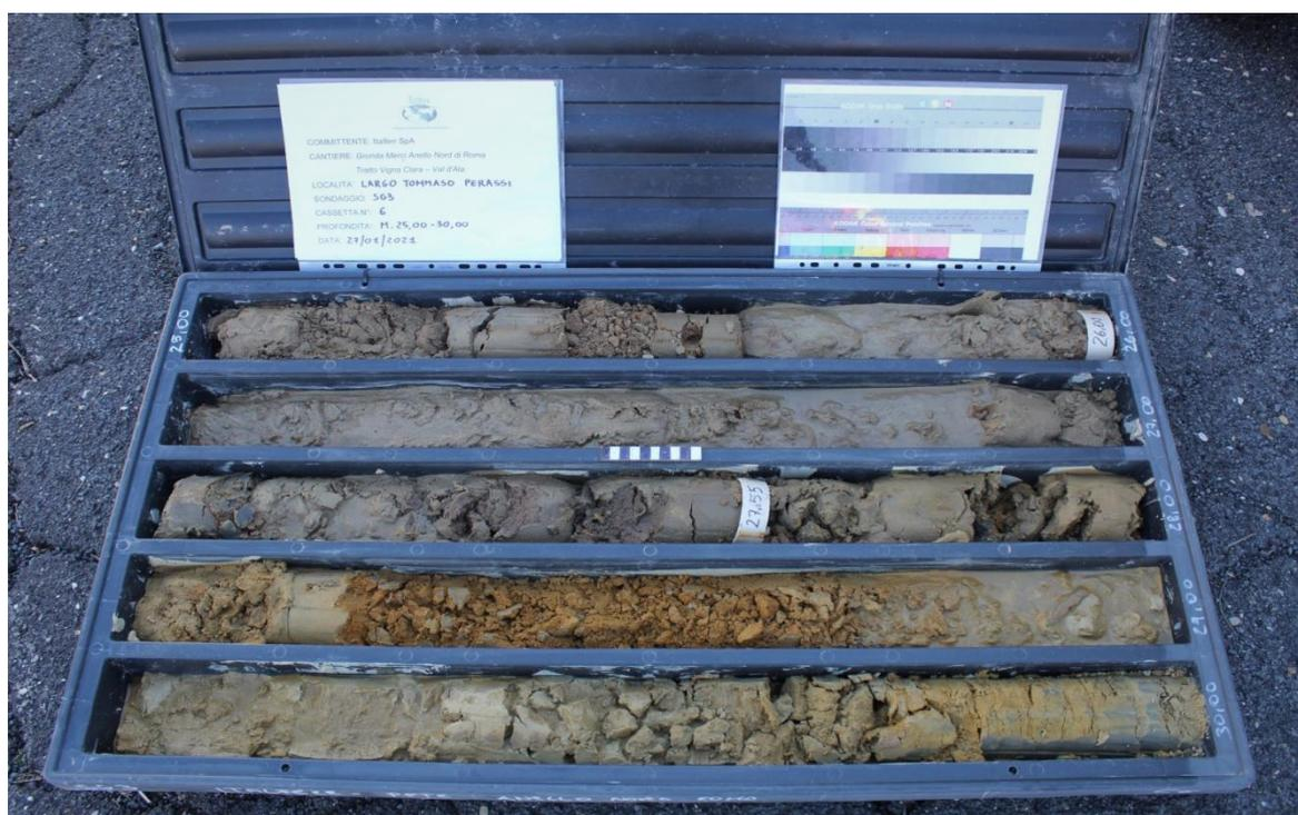
*Sondaggio SG3, carote da -25,00 a -30,00 metri*
