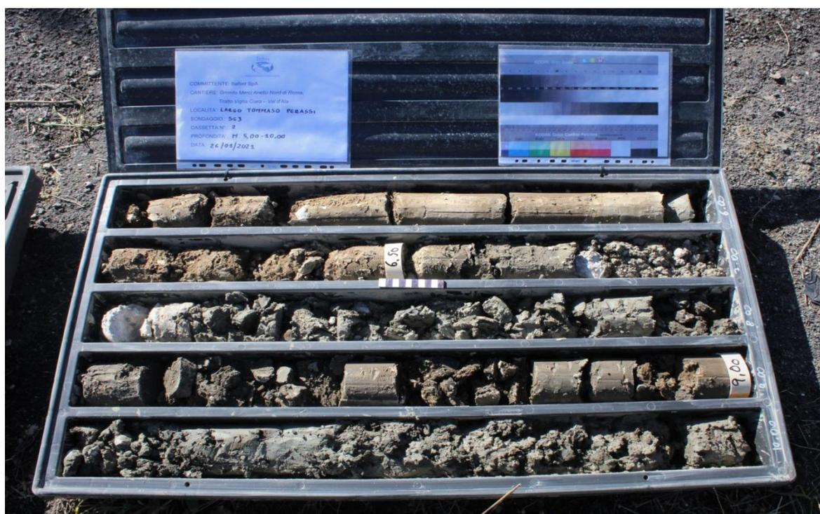
*Sondaggio SG3, carote da -5,00 a -10,00 metri*
