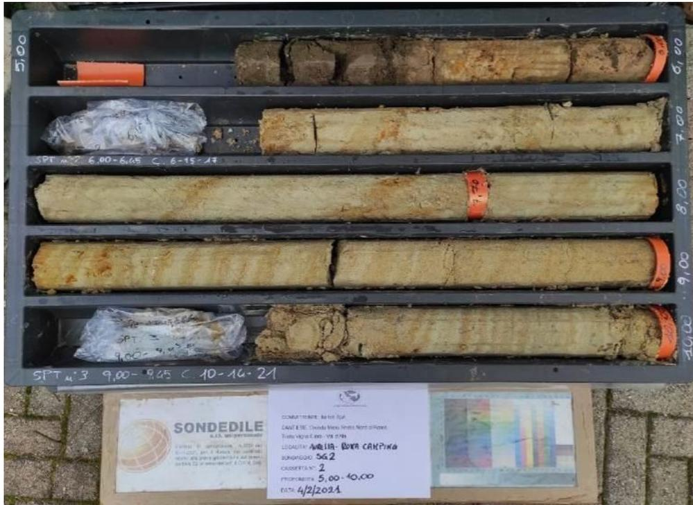
Sondaggio SG2, cassetta 2, da -5,00 a -10,00 metri
