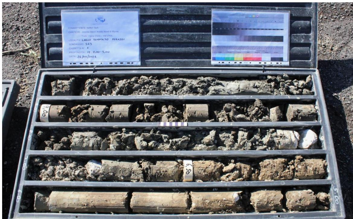
*Sondaggio SG3, carote da 0,00 a -5,00 metri*
