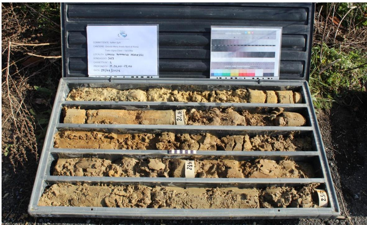
*Sondaggio SG3, carote da -20,00 a -25,00 metri*
