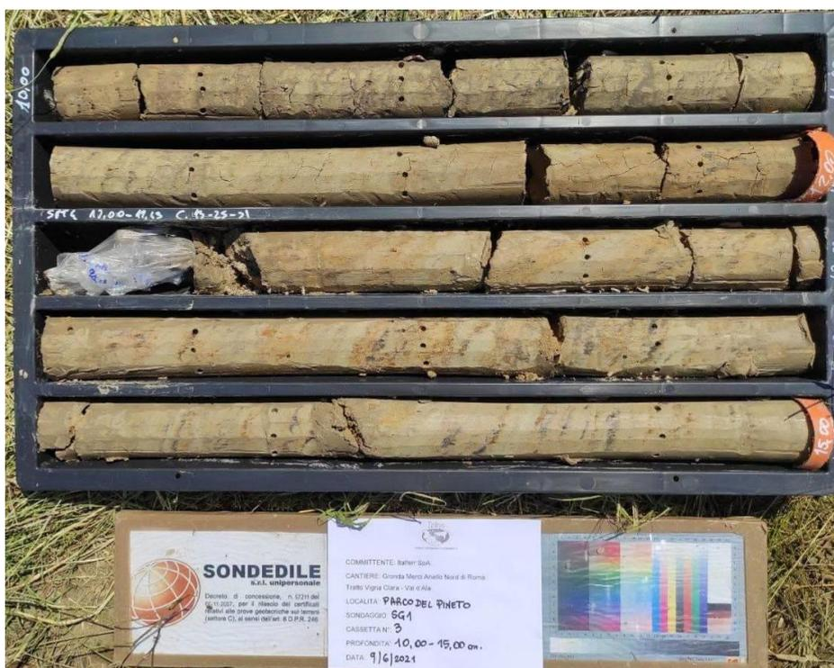
Sondaggio SG1, cassetta 3, da -10,00 a -15,00 metri
