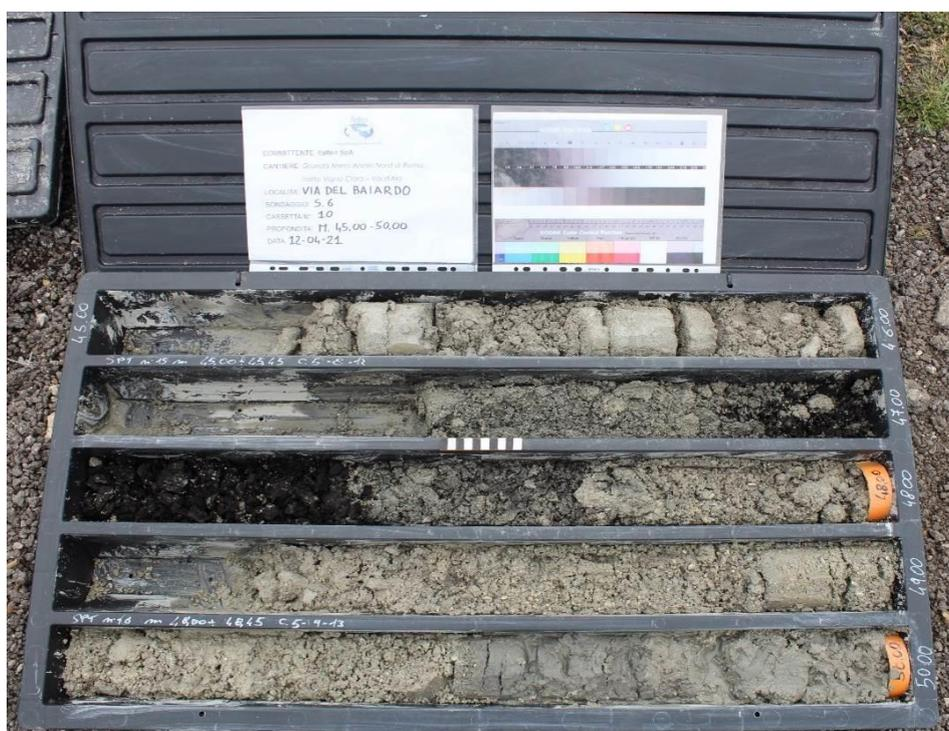
Sondaggio S6, carote da -45,00 a -50,00 metri
