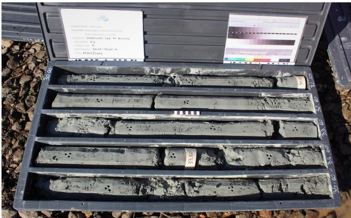
Sondaggio S4, carote da -30,00 a -35,00 metri
