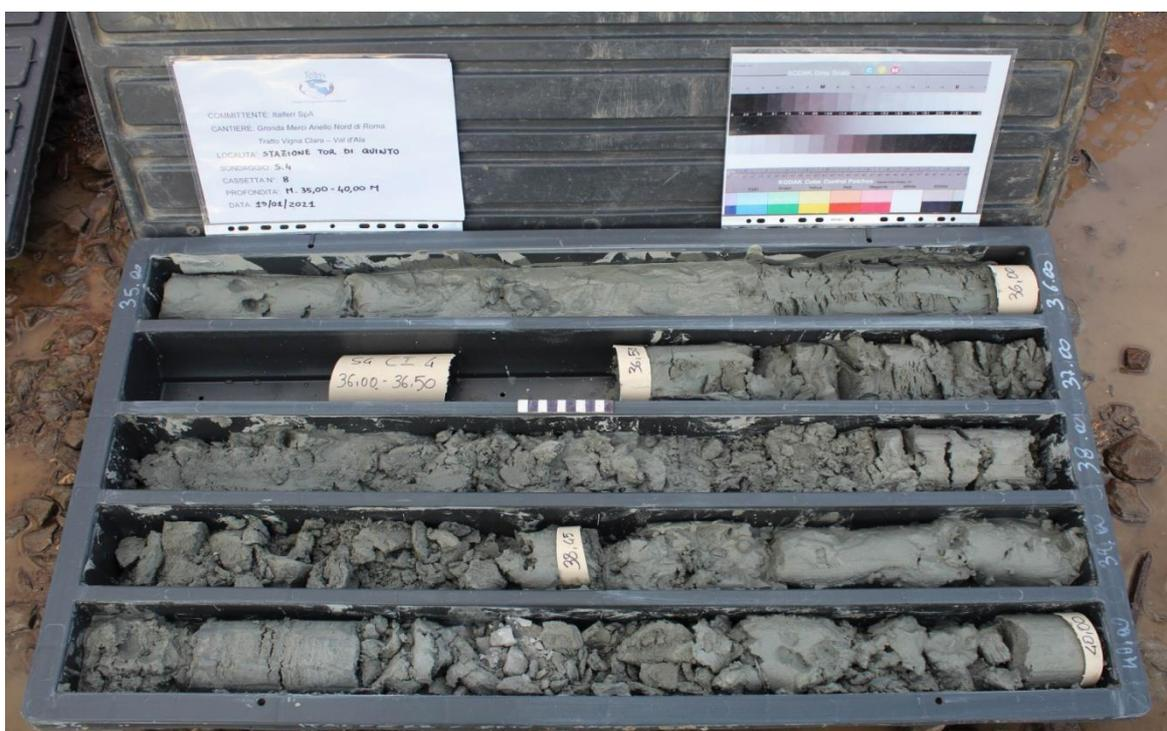
Sondaggio S4, carote da -35,00 a -40,00 metri
