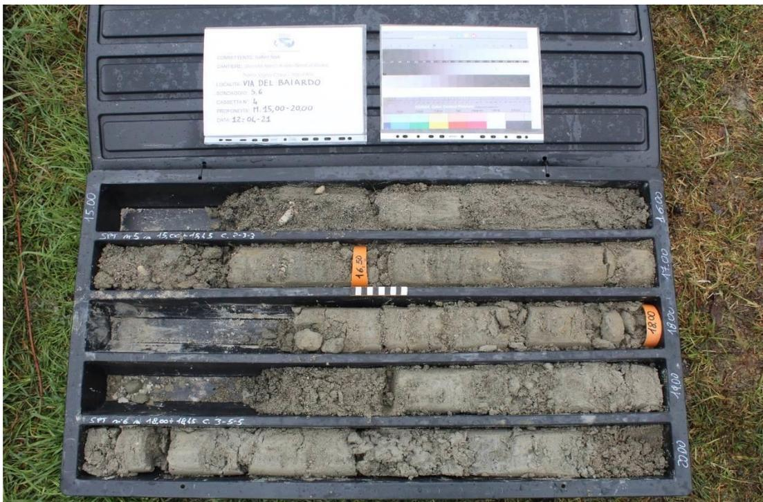
*Sondaggio S6, carote da -15,00 a -20,00 metri*
