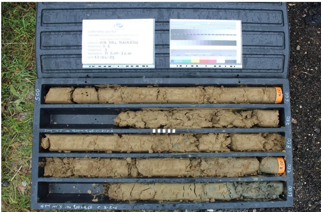
Sondaggio S6, carote da -5,00 a -10,00 metri
