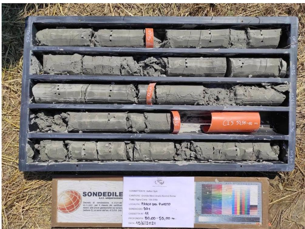
*Sondaggio SG1, cassetta 11, da -50,00 a -55,00 metri*
