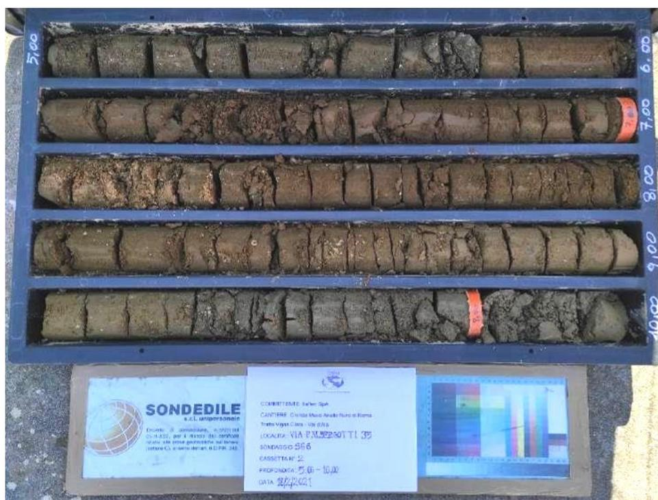
Sondaggio SG6, cassetta 2, da -5,00 a -10,00 metri
