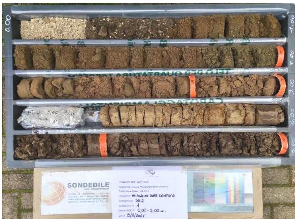
Sondaggio SG2, cassetta 1, da 0,00 a -5,00 metri
