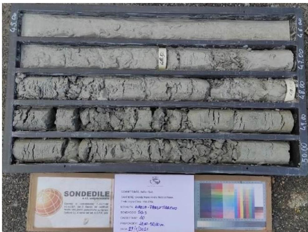
Sondaggio SG5, cassetta 10, da -45,00 a -50,00 metri
