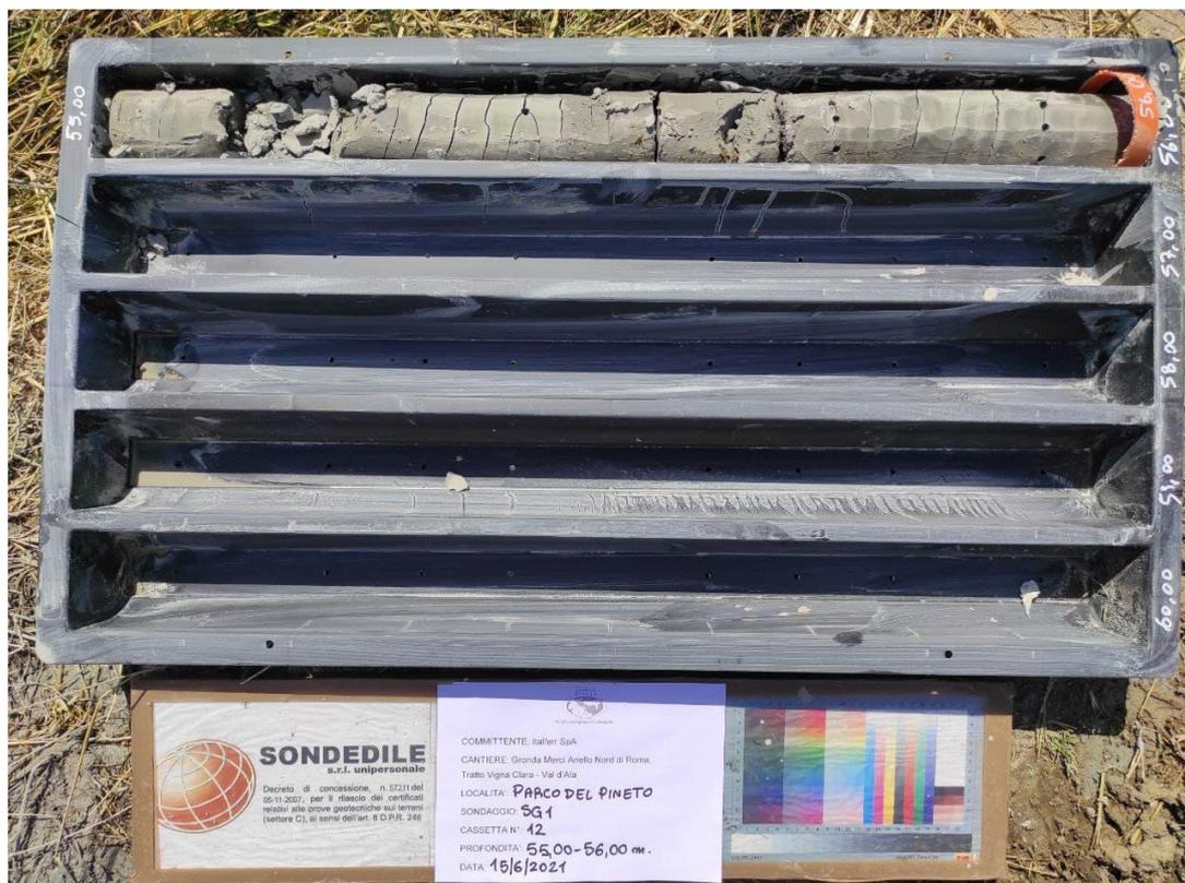
*Sondaggio SG1, cassetta 12, da -55,00 a -56,00 metri*
