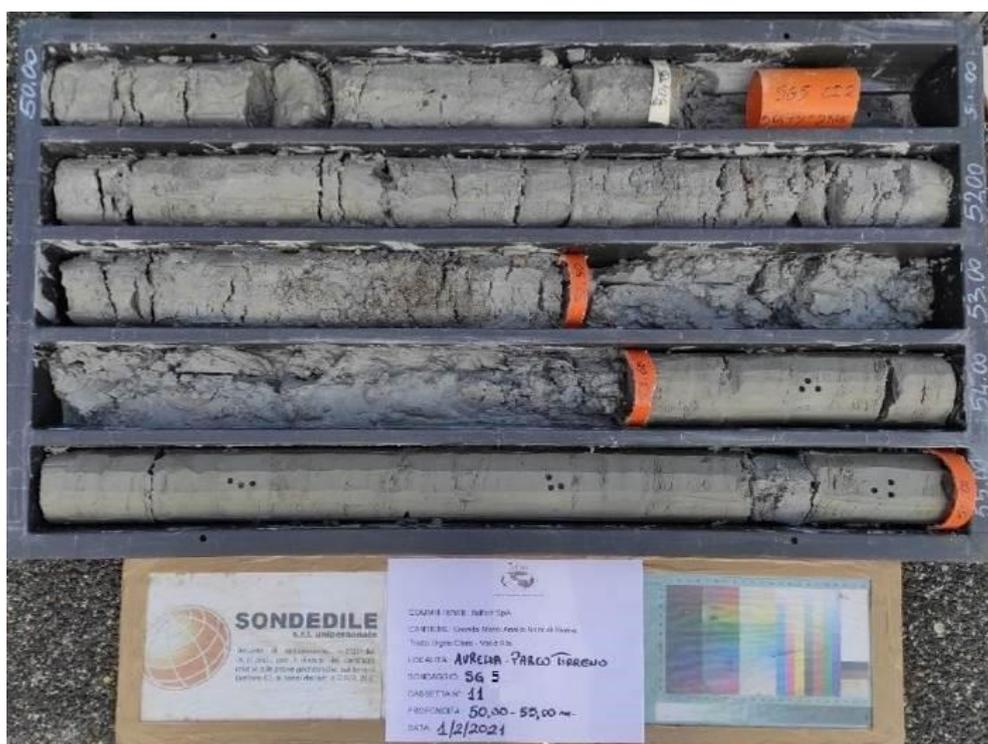
Sondaggio SG5, cassetta 11, da -50,00 a -55,00 metri
