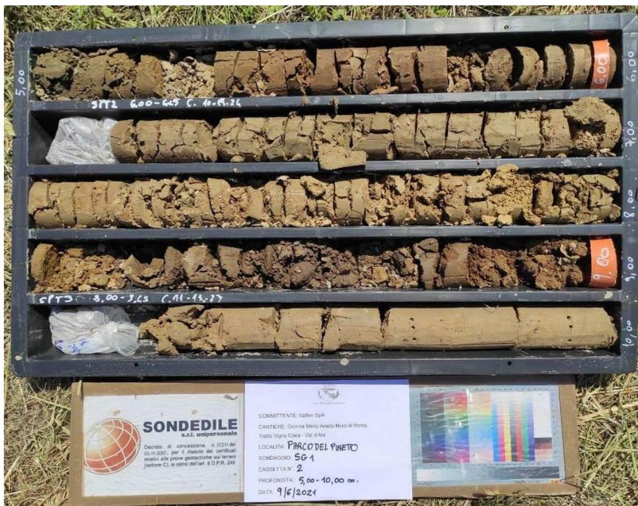
Sondaggio SG1, cassetta 2, da -5,00 a -10,00 metri
