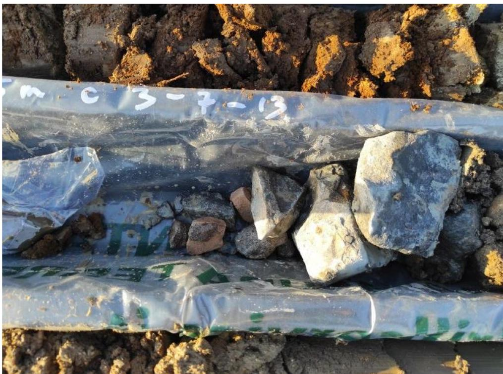
*Sondaggio S1, cassetta 1: laterizi, malta e leucetite da -3,30 a -3,50 metri*
