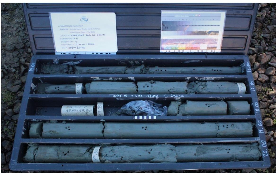
*Sondaggio S4, carote da -15,00 a -20,00 metri*
