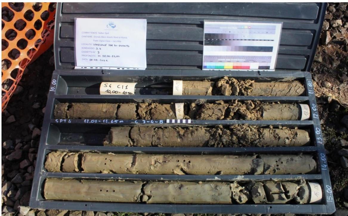
*Sondaggio S4, carote da -10,00 a -15,00 metri*
