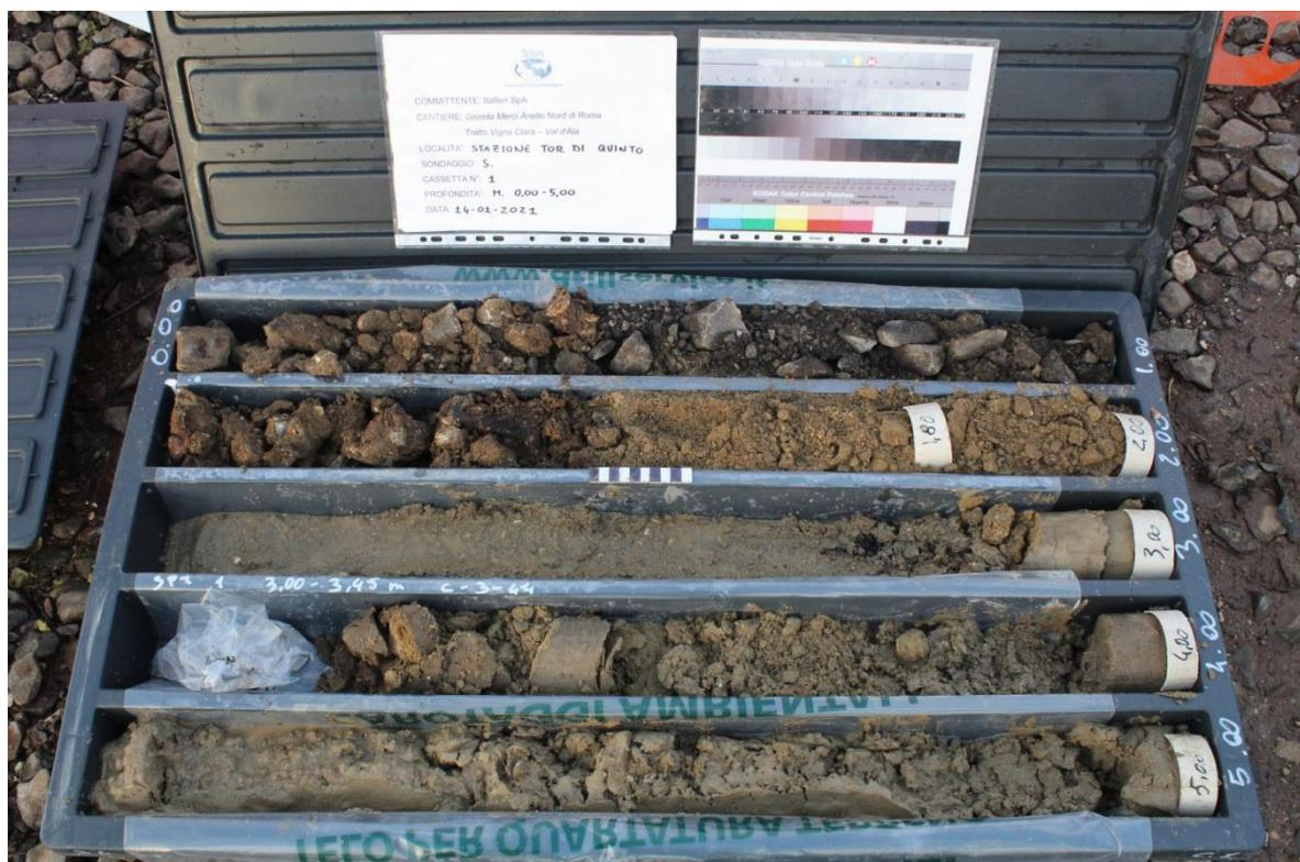
*Sondaggio S4, carote da 0,00 a -5,00 metri*
