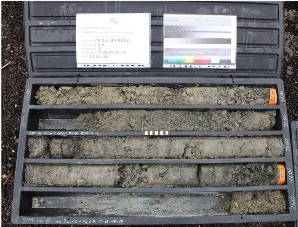
*Sondaggio S6, carote da -20,00 a -25,00 metri*
