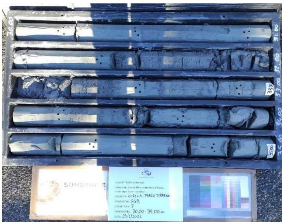
*Sondaggio SG5, cassetta 7, da -30,00 a -35,00 metri*
