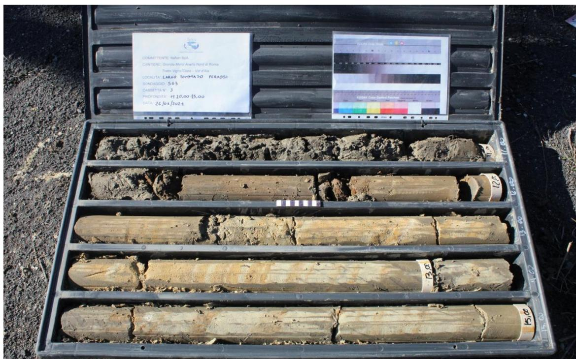
*Sondaggio SG3, carote da -10,00 a -15,00 metri*
