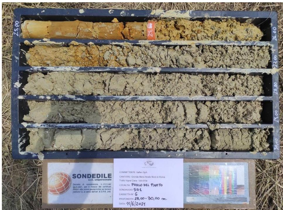
*Sondaggio SG1, cassetta 6, da -25,00 a -30,00 metri*
