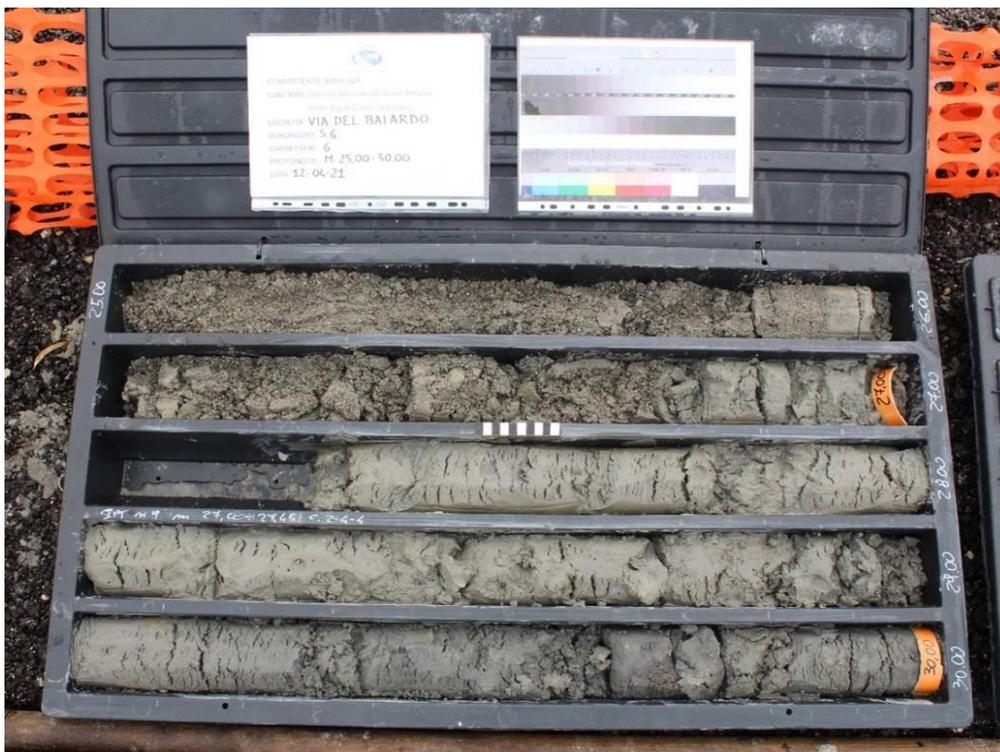
*Sondaggio S6, carote da -25,00 a -30,00 metri*
