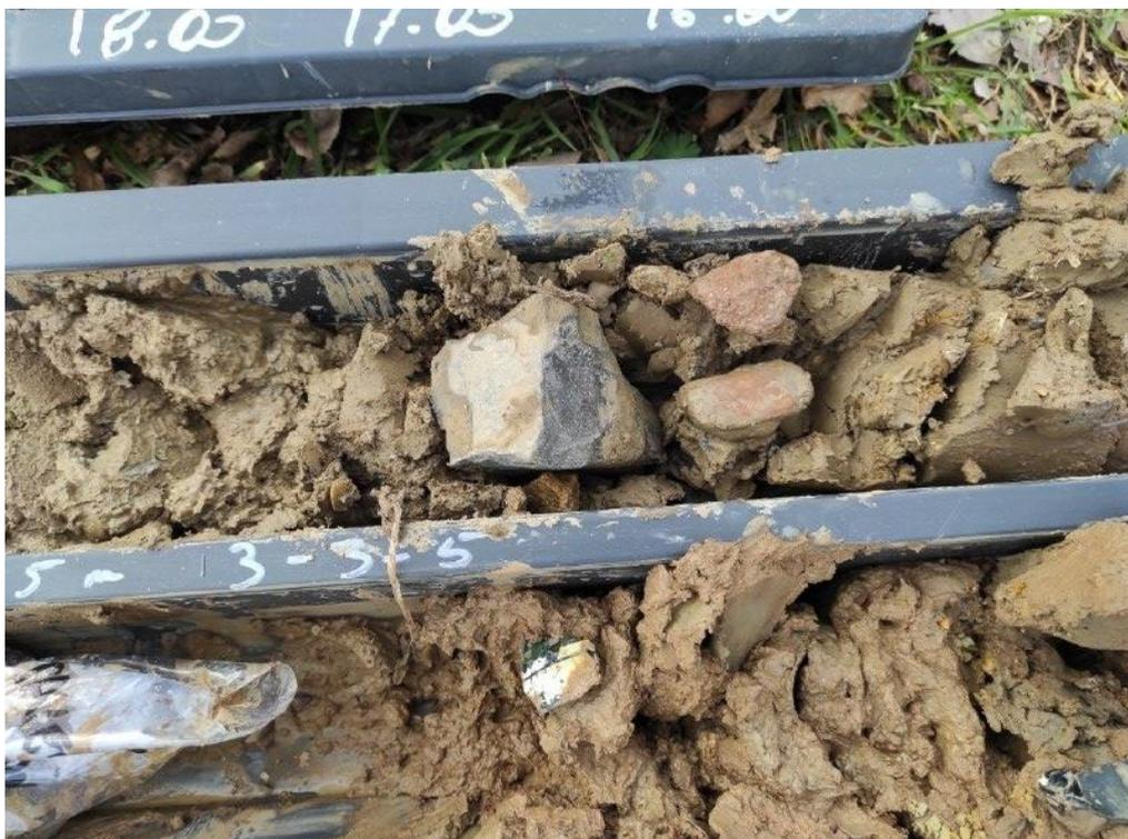
*Sondaggio S1, cassetta 2, da -5,40 a -5,60 m e da -6,40 a -6,60 m.*
