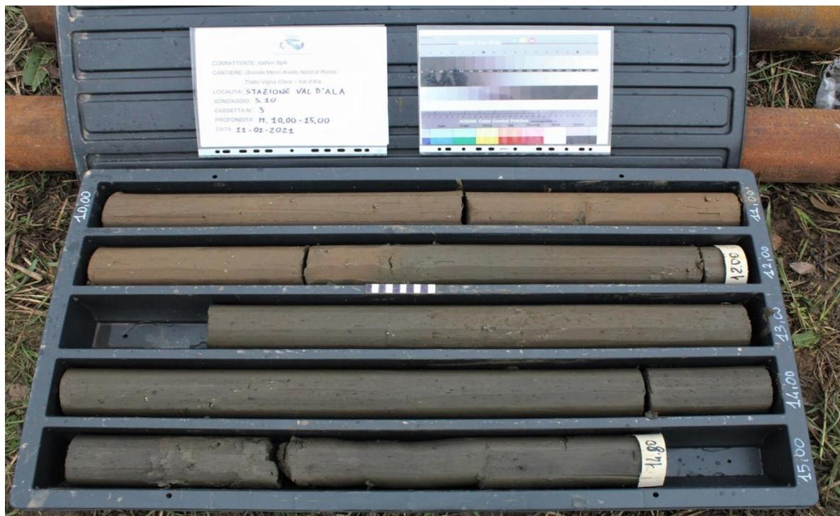
*Sondaggio S10, carote da -10,00 a -15,00 metri*
