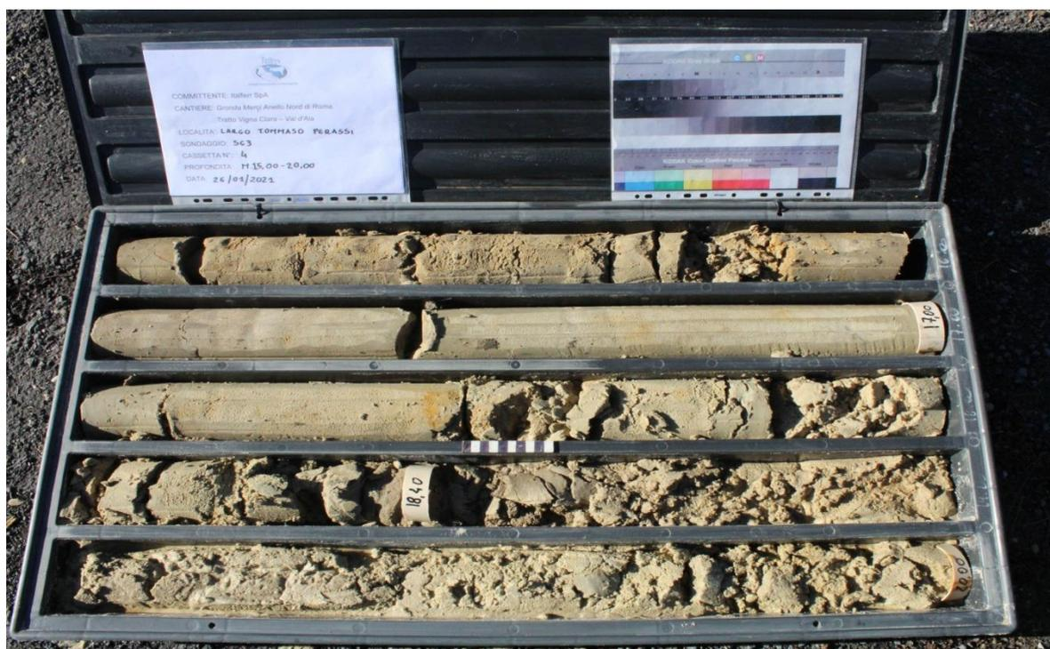
*Sondaggio SG3, carote da -15,00 a -20,00 metri*
