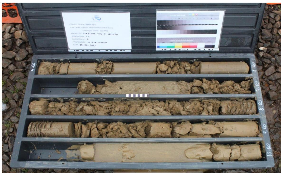
*Sondaggio S4, carote da -5,00 a -10,00 metri*
