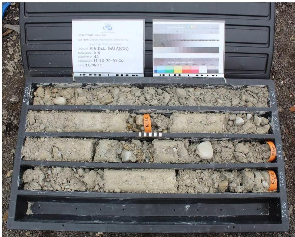
*Sondaggio S6, carote da -50,00 a -55,00 metri*
