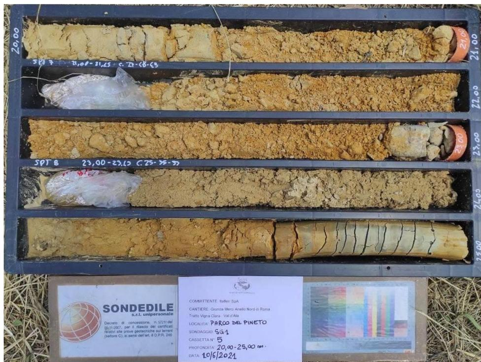
*Sondaggio SG1, cassetta 5, da -20,00 a -25,00 metri*
