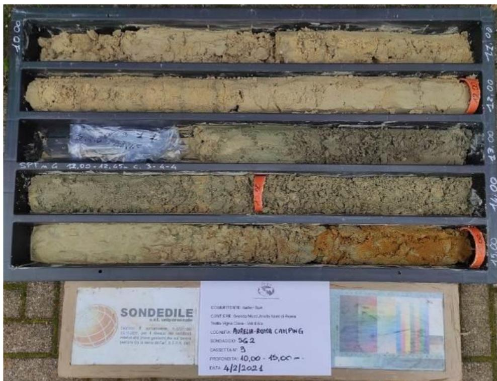
Sondaggio SG2, cassetta 3, da -10,00 a -15,00 metri
