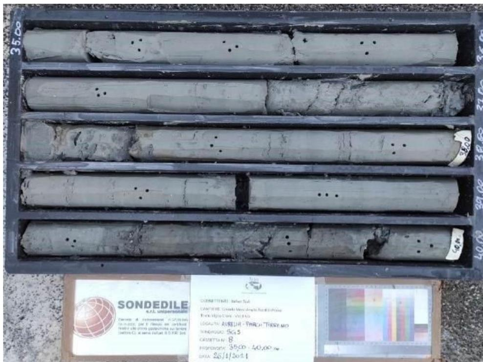
*Sondaggio SG5, cassetta 8, da -35,00 a -40,00 metri*
