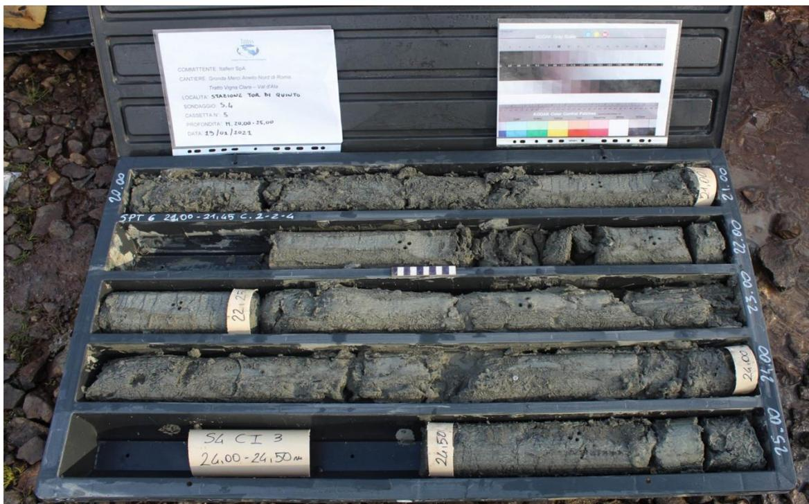
Sondaggio S4, carote da -20,00 a -25,00 metri
