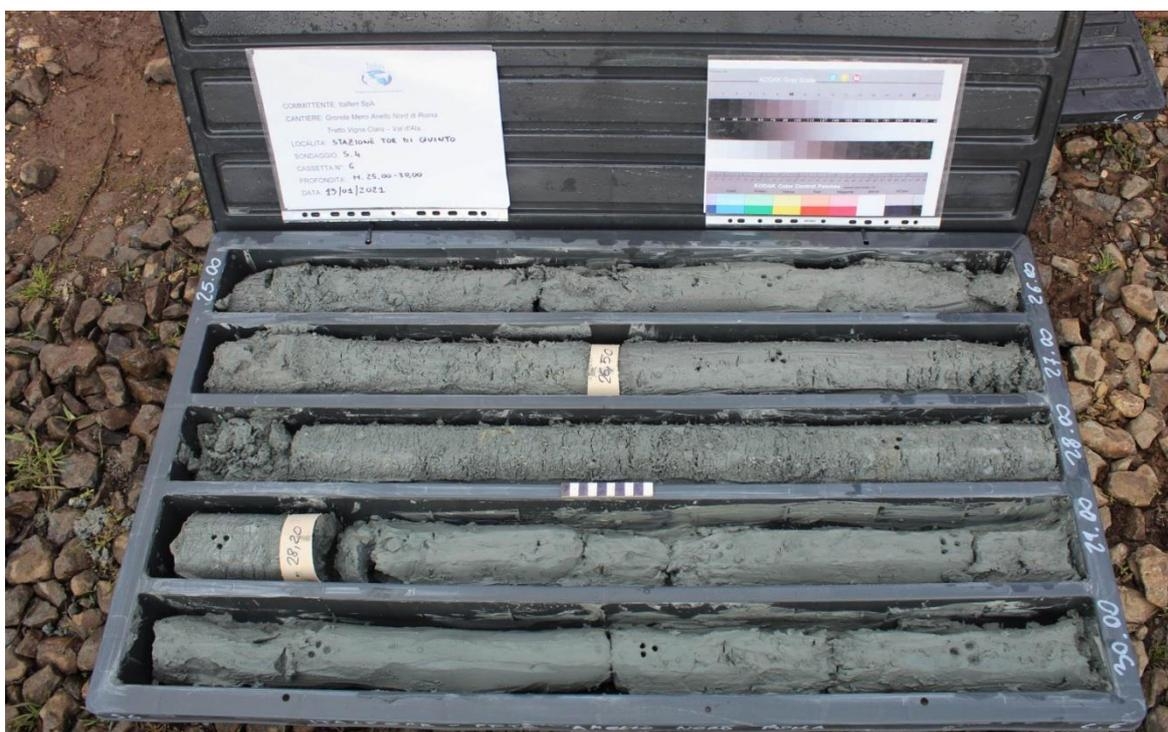
Sondaggio S4, carote da -25,00 a -30,00 metri
