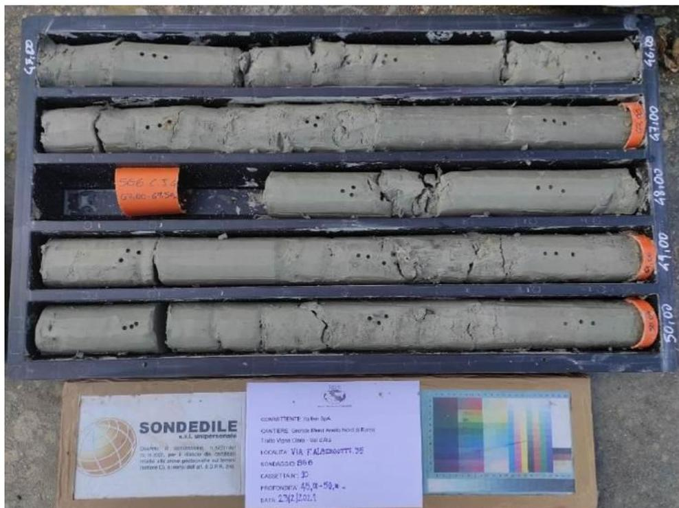
Sondaggio SG6, cassetta 10, da -45,00 a -50,00 metri
