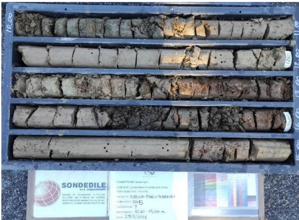
*Sondaggio SG5, cassetta 3, da -10,00 a -15,00 metri*
