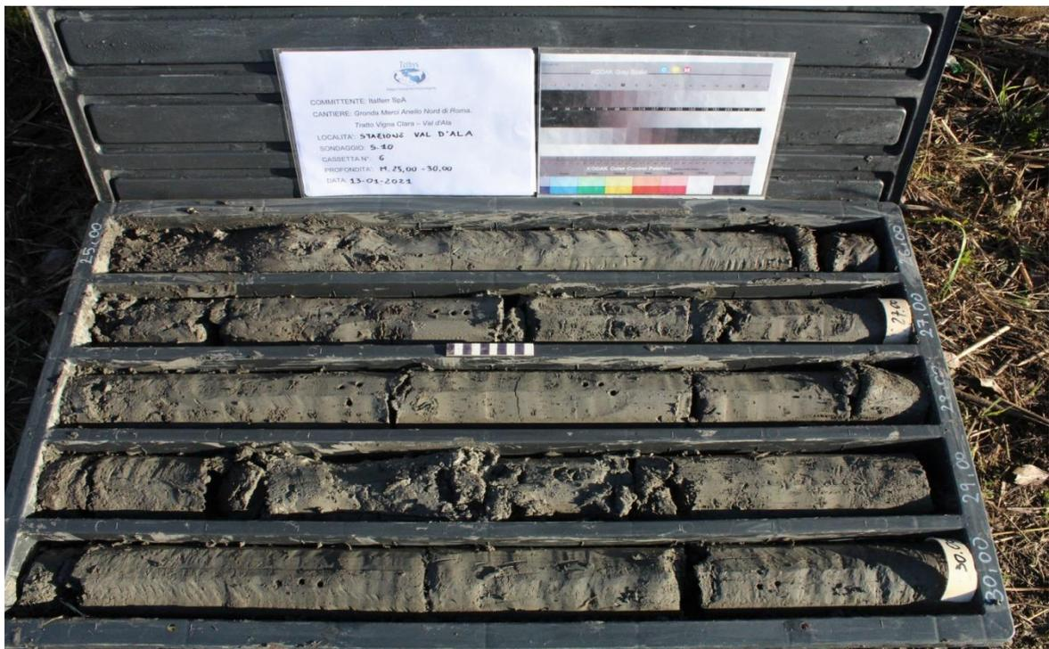
*Sondaggio S10, carote da -25,00 a -30,00 metri*
