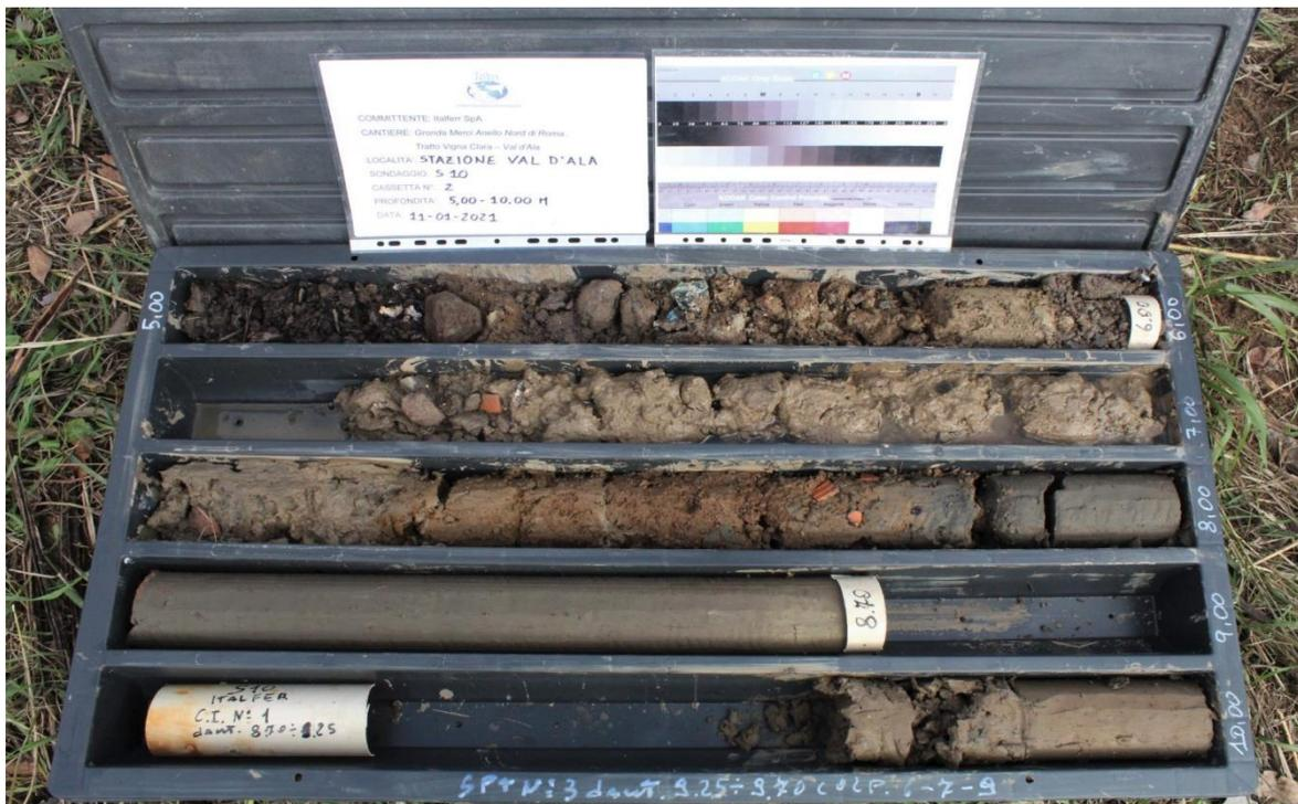
Sondaggio S10, carote da -5,00 a -10,00 metri
