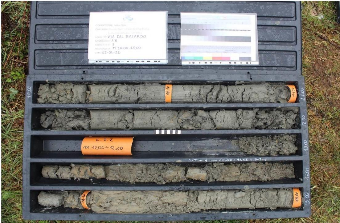
*Sondaggio S6, carote da -10,00 a -15,00 metri*
