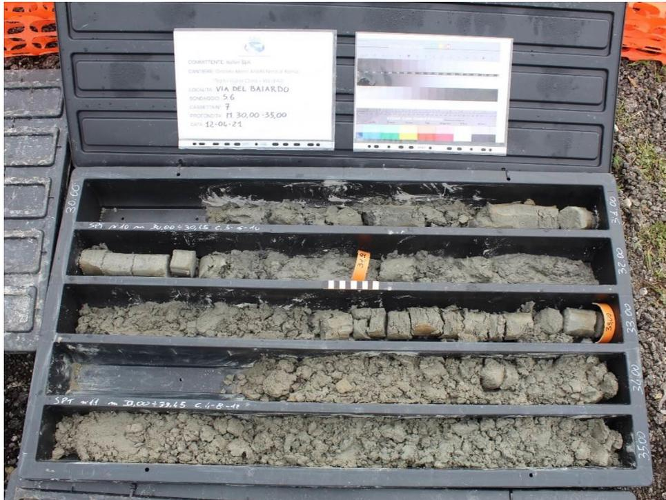
*Sondaggio S6, carote da -30,00 a -35,00 metri*
