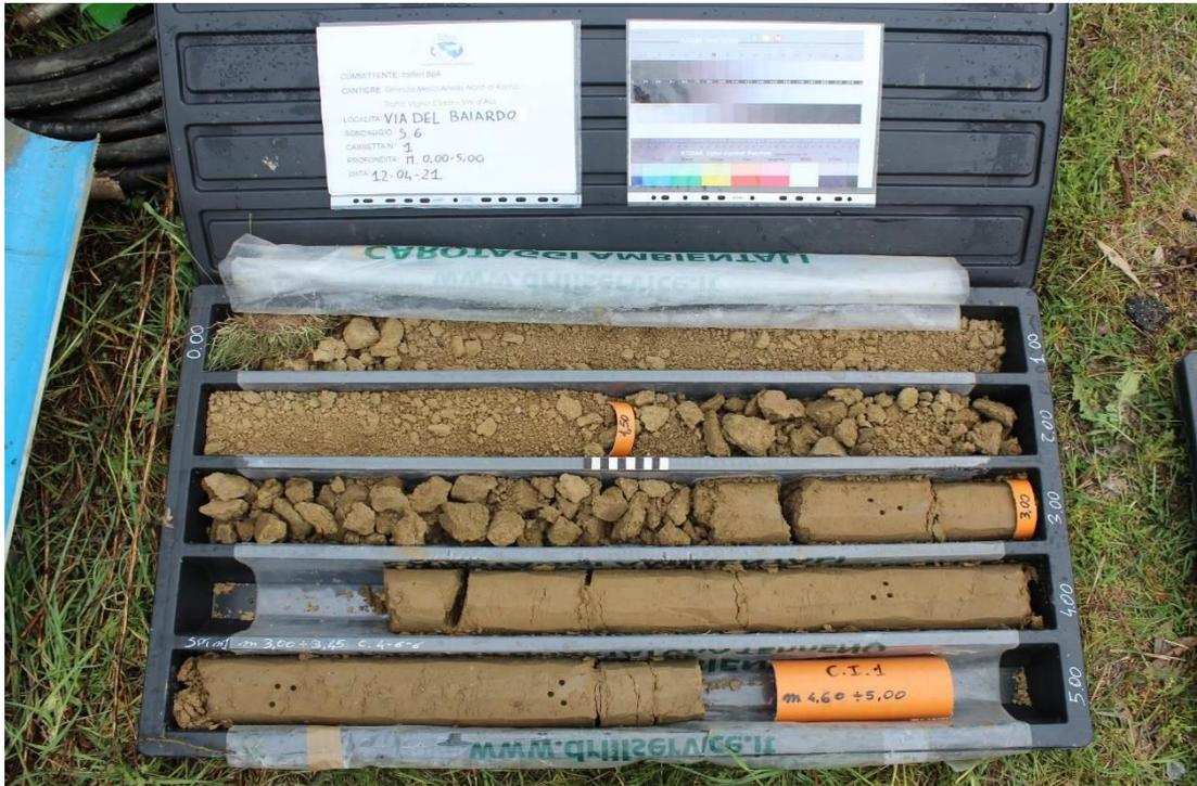
Sondaggio S6, carote da 0,00 a -5,00 metri
