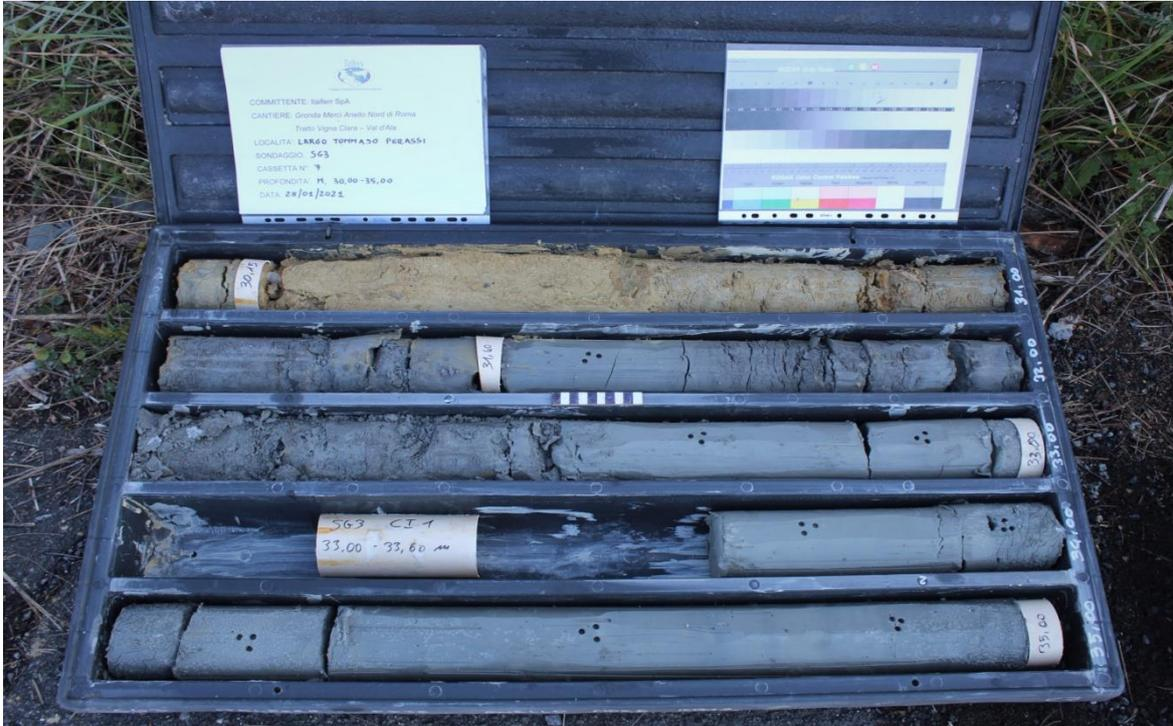
*Sondaggio SG3, carote da -30,00 a -35,00 metri*
