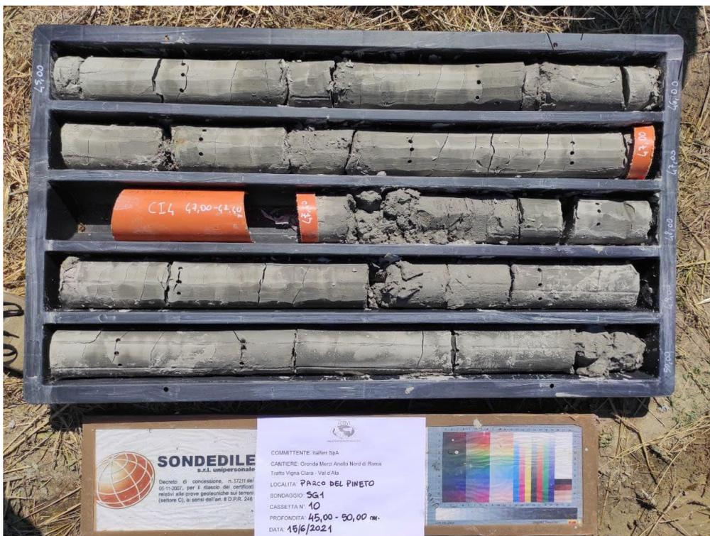
*Sondaggio SG1, cassetta 10, da -45,00 a -50,00 metri*
