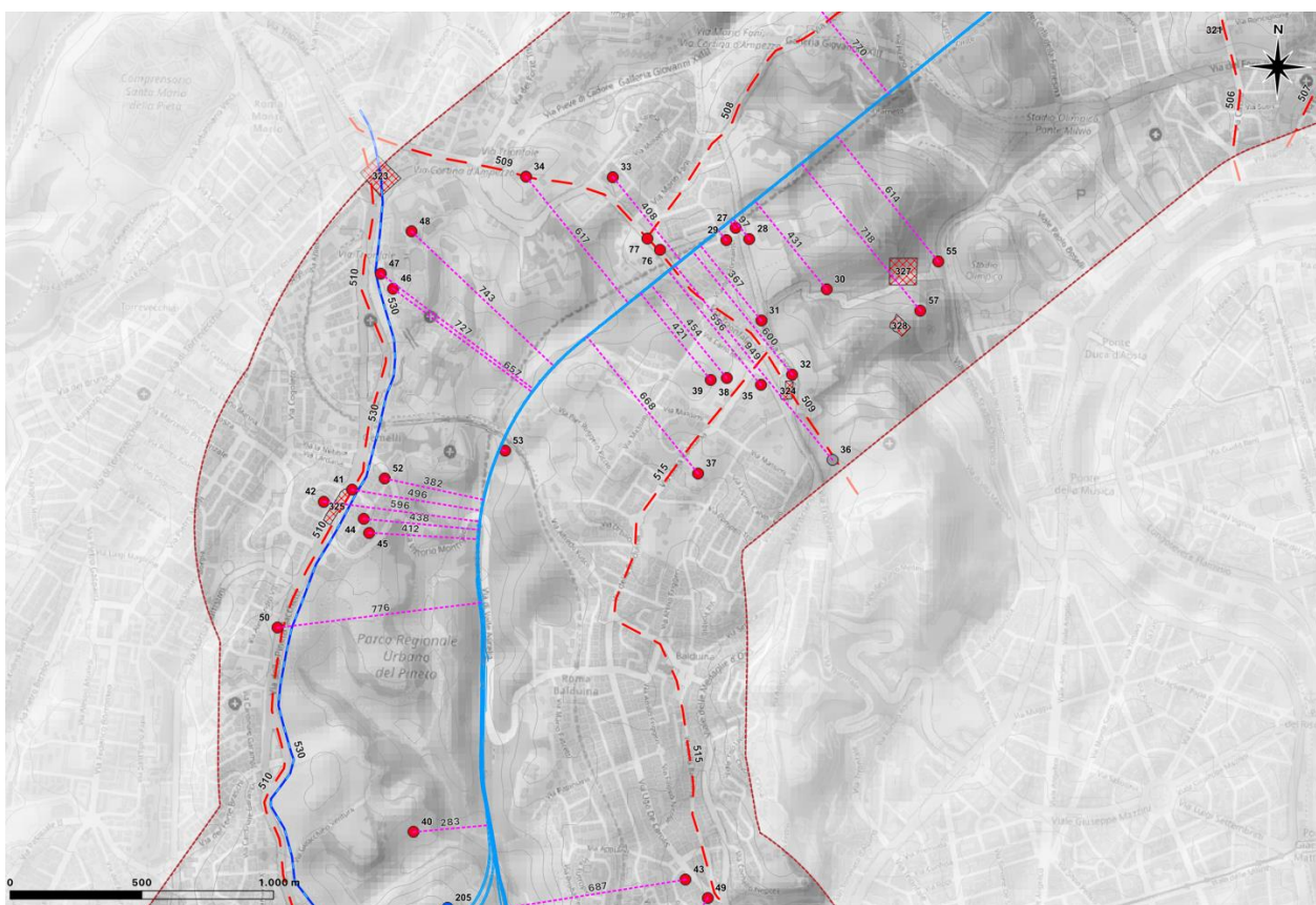
Figura 55 - Presenze Archeologiche: particolare dell'analisi in ambiente GIS del calcolo delle minime distanze delle PA dal tracciato: la cartografia (fonte OSM) è sovrapposta al modello tridimensionale del terreno); in celeste la lineazione semplificata del tracciato.
