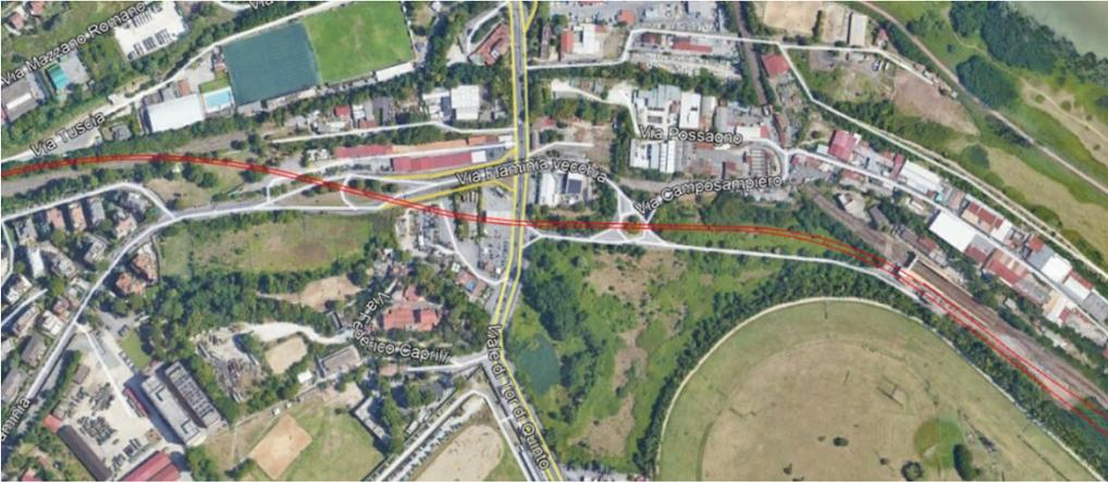
In corrispondenza dell'attraversamento di Via Flaminia, si prevede l'inserimento di due pile all'interno delle aiuole esistenti a centro viabilità (evidenziate in rosso). Le fasi realizzative prevedono la realizzazione di una deviazione provvisoria, mentre in fase definitiva si prevede di riportare la viabilità esattamente alla configurazione attuale. Verranno effettuati degli espropri temporanei per consentire la realizzazione delle deviazioni provvisorie.
