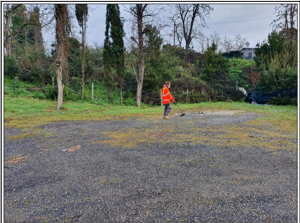
**Sondaggio S1-Rilievo masse metalliche**
