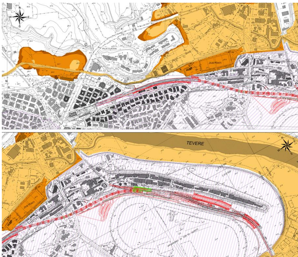
Figura 5-25 Aree di pericolosità idraulica da P.G.R.A. in corrispondenza del Lotto 1B (fonte: Autorità di bacino distrettuale dell'Appennino Centrale).
