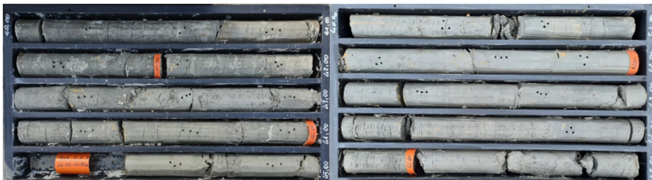
Litofacies argilloso-sabbiosa della Formazione di Monte Vaticano (MVA) nei fori di sondaggio SG6 (a sinistra) e S11 (a destra).
