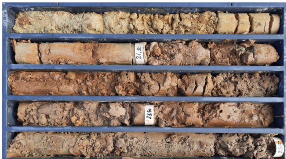
Litofacies sabbioso-limosa della Formazione di Ponte Galeria (PGL3c) in corrispondenza del foro di sondaggio SG3.
