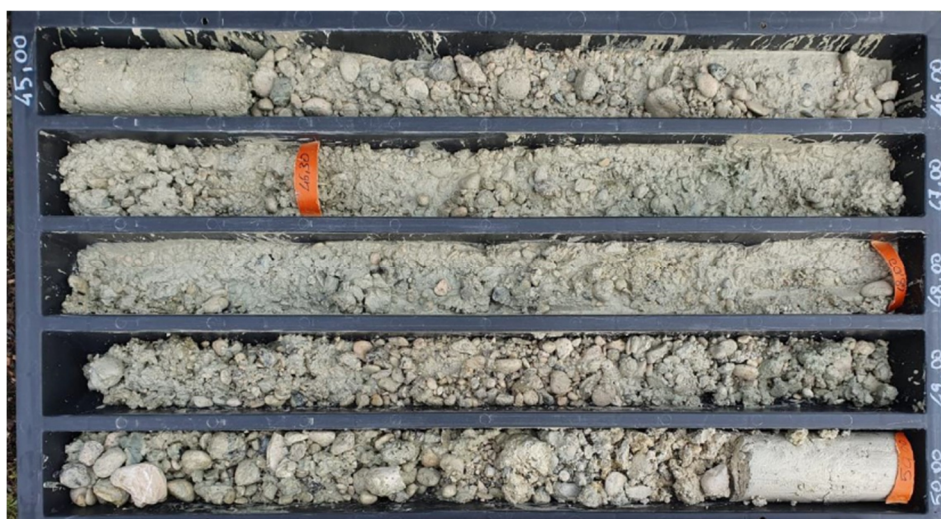
Litofacies ghiaioso-sabbiosa dei Depositi alluvionali recenti (bb1) nella parte bassa del foro di sondaggio S1.
