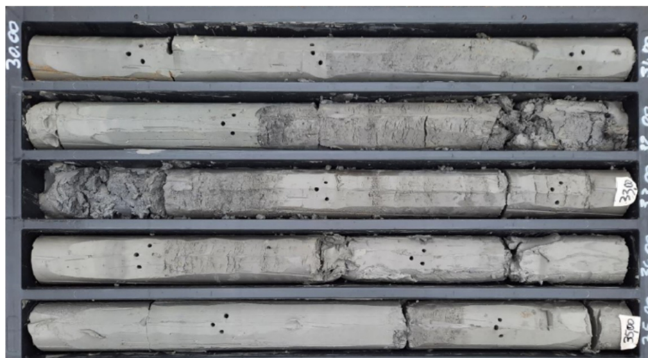
Litofacies argilloso-sabbiosa della Formazione di Ponte Galeria (PGL3b) in corrispondenza del foro di sondaggio SG5.
