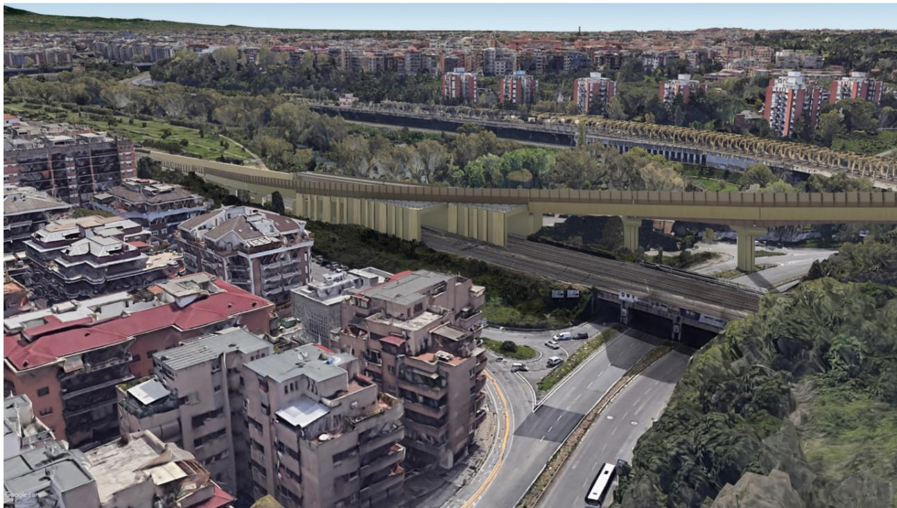
Figura 70: Vista dall'alto punto di scavalco via Prati Fiscali – stato di progetto con soluzione scatolare
