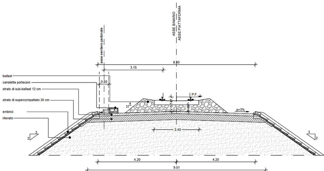
**Sezione tipo in rilevato – singolo binario**
