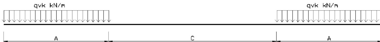
Figura 5 – Treno di carico SW
