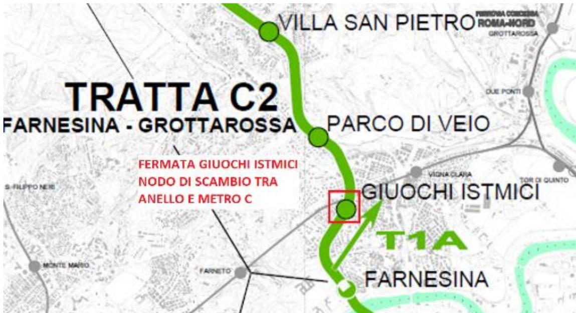
Una proposta alternativa, per evitare una fermata così ravvicinata l'una all'altra, consiste di deviare il tracciato della Metro C per sottopassare la fermata sull'Anello di Vigna Clara e lì realizzare il nodo di scambio.
