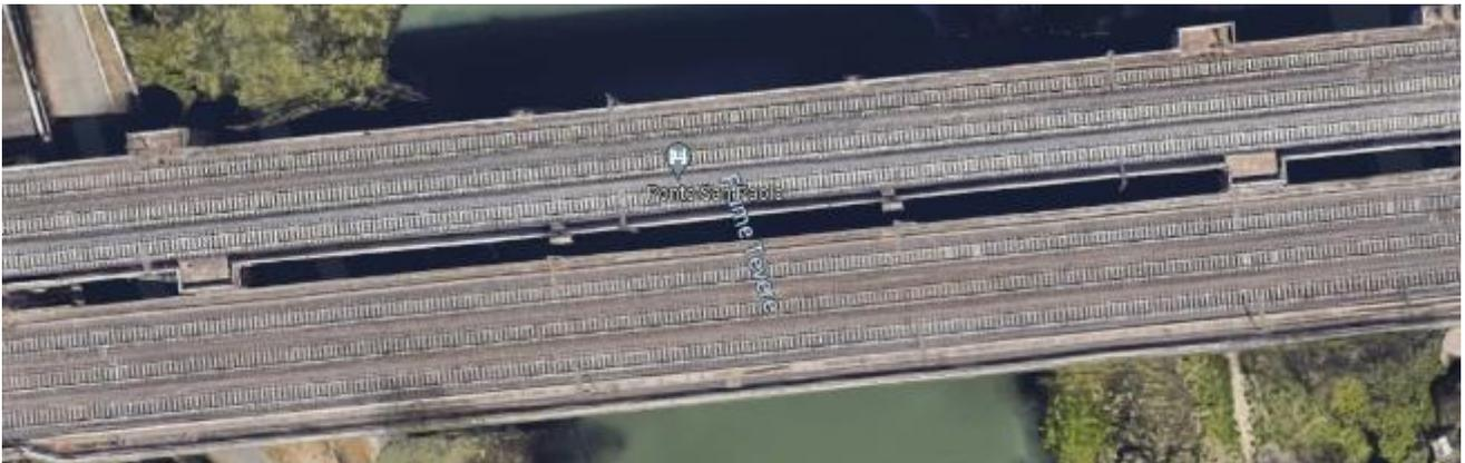
Si propone di realizzare subito il ponte ferroviario predisposto per il quadruplicamento. Si propone di propagare tale modifica a 4 binari fino alla Stazione di Tor di Quinto.
