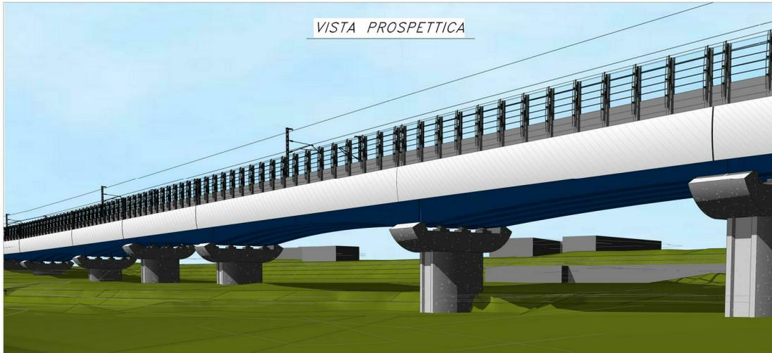
*Figura 12. Vista prospettica - Ponte a struttura mista acciaio calcestruzzo a doppio binario*
